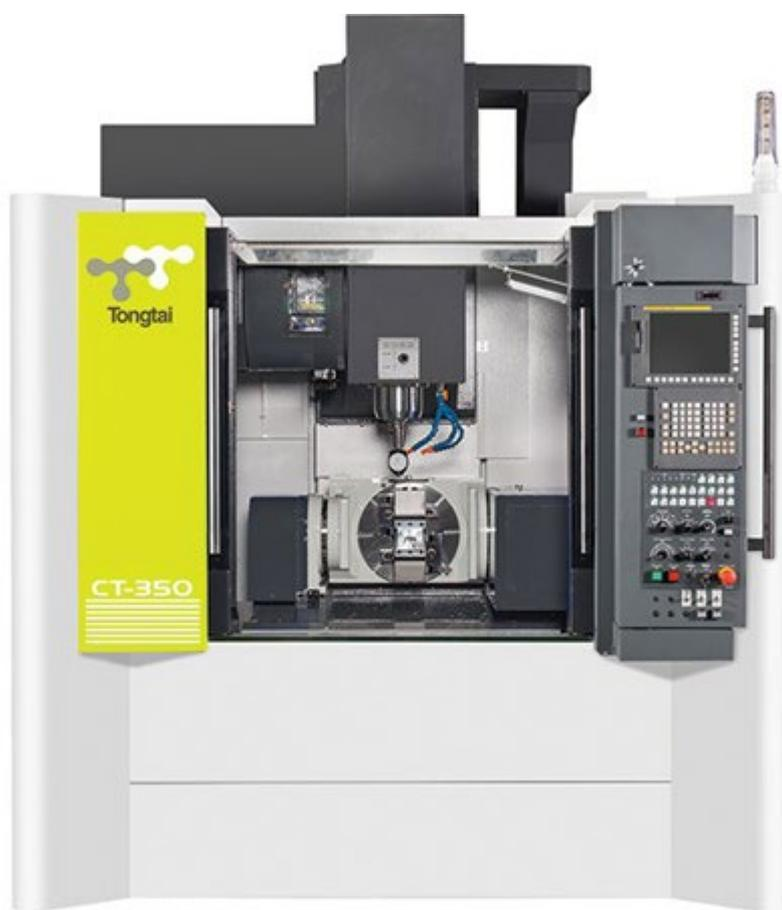
**Pesant plus de 7 tonnes, le centre d'usinage vertical est pourvu d'un 4e et 5e axe de type « tilting ».**
