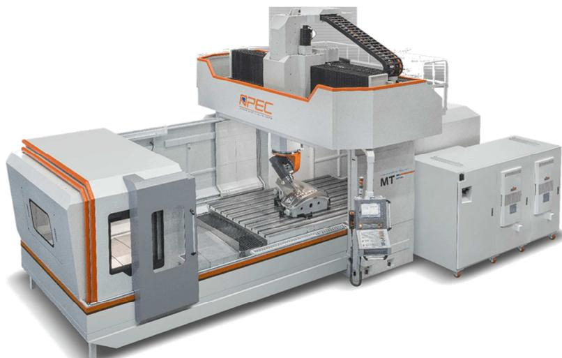
Le centre à portique 3 axes APEC série MT24 est une machine très dynamique pour l'usinage de pièces de grandes dimensions. La course en Y de ces machines est de 2500mm pour une largeur de bridage de la table de 2060mm.
