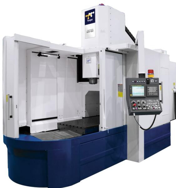
Le centre d'usinage vertical MDV est un centre destiné à l'UGV. Il est doté d'une structure en forme de portique particulièrement rigide et qui améliore sensiblement la précision de la machine est les états de surfaces des pièces usinées.
